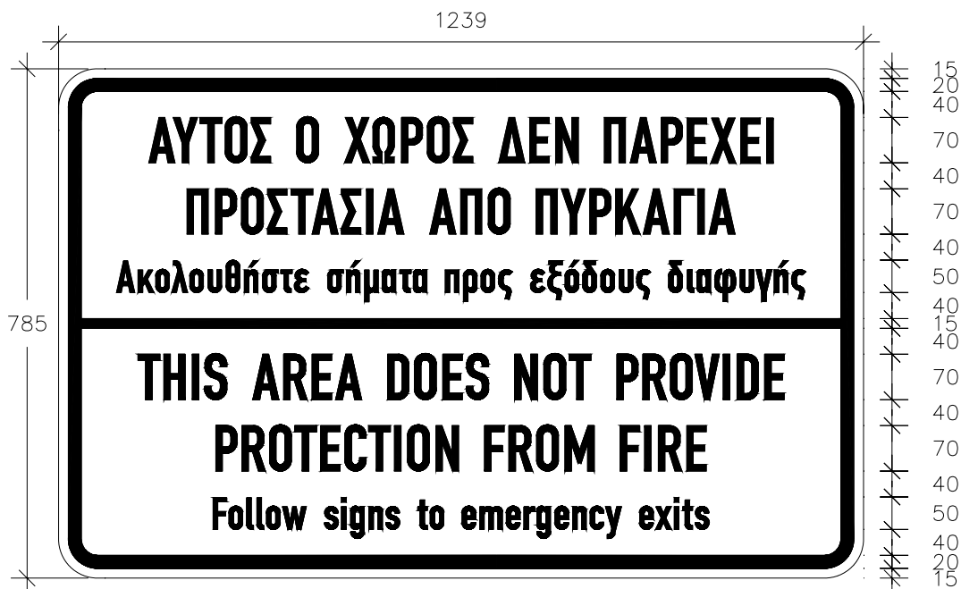
Σχήμα 20.6-4: Πινακίδα τοποθετούμενη σε εσοχές της σήραγγας όπου δεν προσφέρεται προστασία από πυρκαγιά. (Το υπόβαθρο είναι από αντανακλαστική μεμβράνη τύπου II χρώματος λευκού, οι αναγραφές με χαρακτήρες από μεμβράνη χρώματος μαύρου).
