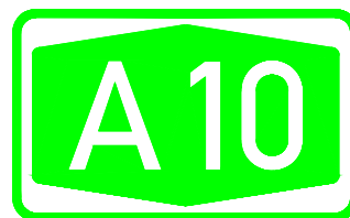
Σχήμα Ι: Έμβλημα με τον αριθμό του αυτοκινητοδρόμου Διαστασιολόγηση ( e = N = 1/7 z , z = ύψος στοιχείων εμβλήματος)
