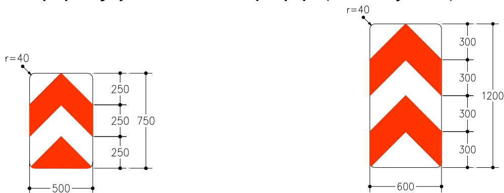
Σχήμα 36: Τυποποιημένα μεγέθη κατευθυντήριας πινακίδας τοποθετούμενης σε αιχμές διαχωρισμού οδοστρώματος εξόδου από αυτοκινητόδρομο (Διαστάσεις σε mm)
