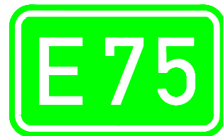
Σχήμα II: Έμβλημα με τον αριθμό της κύριας διεθνούς οδικής αρτηρίας (E-road) ( e = N = 1/7 z , z = ύψος στοιχείων εμβλήματος)
